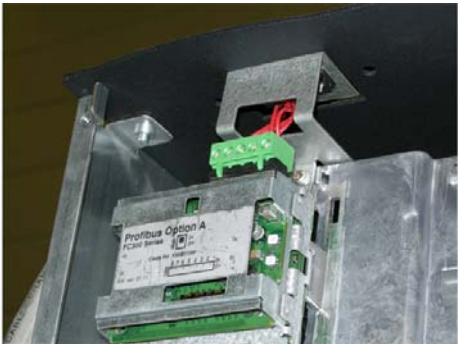
Рисунок 3.52: Подключение шины fieldbus сверху.
